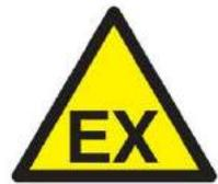
Die Waage darf nicht in explosionsgefährdeter Umgebung gelagert und verwendet werden.
