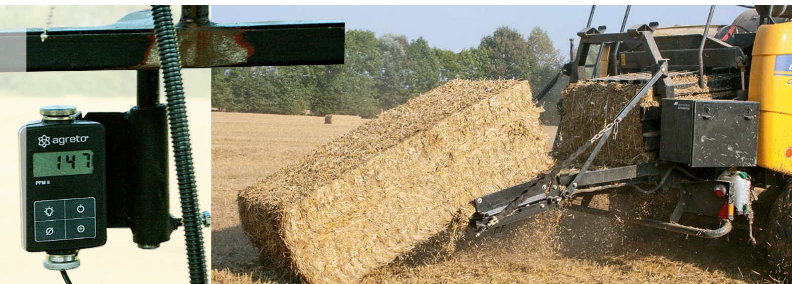
Stroh und Heu sollten trocken sein, wenn es gepresst wird. Die Anzeige des nachrüstbaren Pressenfeuchtemessers Agreto PFM II zeigt im Sekundentakt die Ballenfeuchte an. Fotos: Böhrnsen (2), Tovornik
