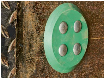
Die Sensorplatte wird auf halber Höhe und ca. 50 cm vor Ende des Presskanals eingebaut.
