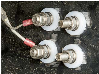
An zwei nebeneinanderliegenden Schrauben wird das Sensorkabel befestigt.
